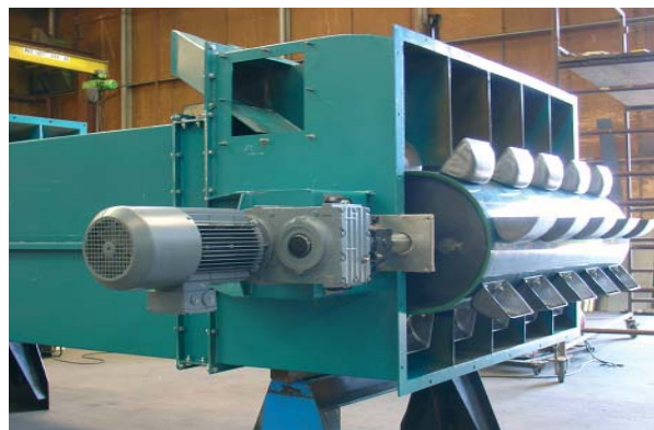
Fünflingsbecherwerk für das Getrennthalten von Farbstoffen in Fertigungsprozessen in Steinfabriken.
