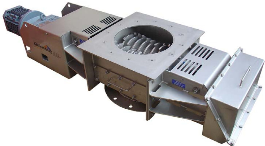
Klinkenberg HT-Knollenbrecher bis 300 °C. Durch Einzelantrieb angetriebene zwei Wellen. Wassergekühlte Wellenzapfen, Dichtungen und Zahnräder.
