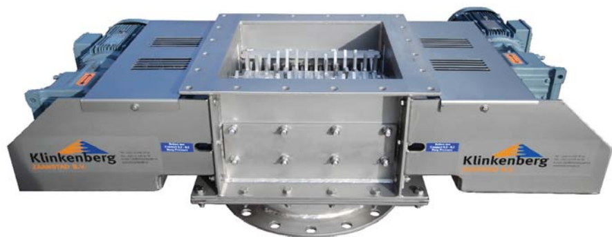
Zweiwellig angetriebener Knollenbrecher mit Messer zum Brechen von sehr harten Agglomeraten. Pro Welle gibt es einen Antrieb. Die Messer können ausgewechselt
