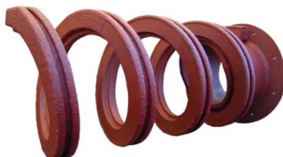
Aufgeschweißtes Spiralpressband mit verschleißfester Elektrode
