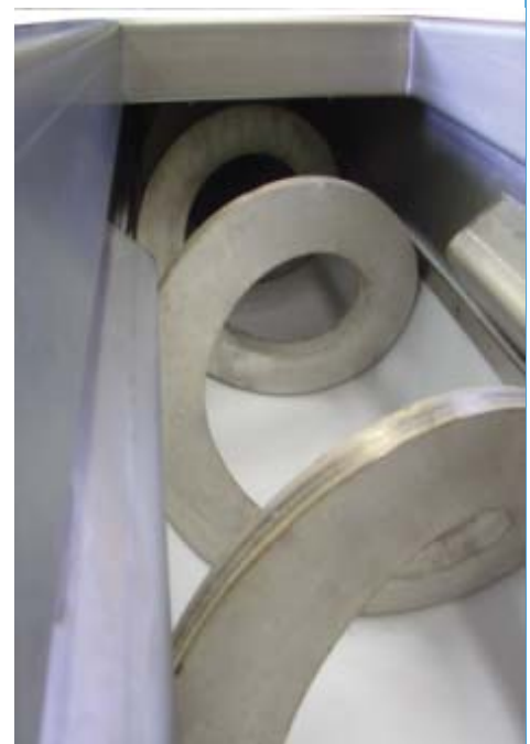
Spiralförderer komplett aus 1.4404 Modell mit Niederhalter
