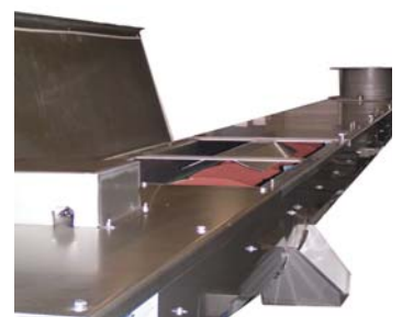
Erwärmte Ausführung für das Vortrocknen.
