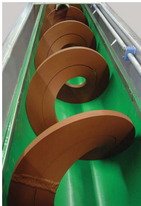
Spiralförderer, Gehäuse aus 1.4301 liner HDPE-1000 mit Sprühdüsen
